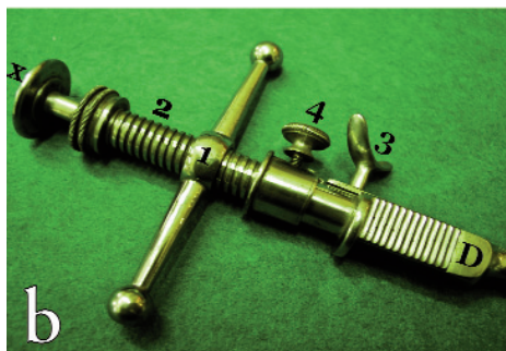
Abb. 3: Weiss'scher Lithotriptor aus dem Jahr 1833/34. „Sliding Instrument“ mit „gespaltenem Schnabel“ für „Kompression“ (vielleicht auch für „Perkussion“) 3a. Gesamtansicht von oben. Das Instrument (distaler Schnabel) nur wenig geöffnet. 3b. Detail: Blick von der Seite: Markierung D: bereits moderneres „kubisches Metallgebilde“ (unbeweglicher, „weiblicher“ Teil). 1: Schraubenmutter mit großen Griffen. 2: Gewindestange (beweglicher, „männlicher“ Teil). 3: Griff für das Verschieben des freigegebenen „männlichen“ Teils. 4: Rohrstück mit Schraube (Kupplungsstück zwischen Gewindestange und Rest des „männlichen Teils“?). X: Möglicher Einsatz auch für „Perkussion“(?) (Die Aufgabe des Mechanismus für die „Kompression“ war es, den beweglichen („männlichen“) Teil nach distal (nach abwärts) zu schieben, um damit die Distanz zwischen den beiden Schnäbeln (den beiden Teilen des „gespaltenen Schnabels“) zu verkleinern und durch Erhöhung des Drucks auf den Stein, diesen zu zerbrechen.) 3c. Detail: Blick von oben. Markierung B: Verschiebbarer, „männlicher“ Teil des Lithotriptors, der nach oben hin Zahlen (für die Größe des Steins bzw. die Distanz zwischen den beiden Schnäbeln) aufweist. B liegt in C und D. C: Proximales Stück des nicht-beweglichen, „weiblichen“ Teils. D: Das „kubische Metallgebilde“. Bei diesem Lithotriptor von Weiss liegt B nach oben hin in diesem Abschnitt frei, ist daher sichtbar dargestellt. 1: Schraubenmutter mit großen Griffen. 2: Gewindestange. 3: Griff für das Verschieben des freigegebenen „männlichen“ Teils. 4: Rohrstück mit Schraube (Kupplungsstück zwischen Gewindestange und Rest des „männlichen Teils“?). X: Möglicher Einsatz für „Perkussion“(?)
